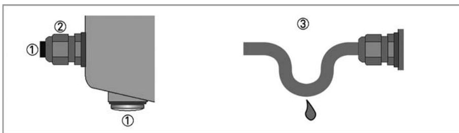
Рисунок 4-9: Кабельный проходник
